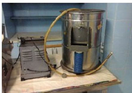
Ausência de instalações hidráulicas para uso do descascador, conforme informado pelos manipuladores de alimentos.
